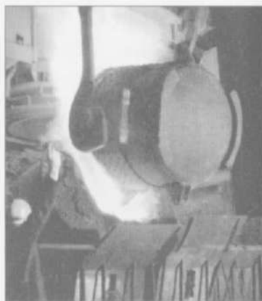
Рис. 23. Заполнение кислородного конвертера расплавленным чугуном
